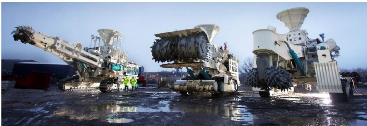
Équipements pour l'exploitation sous-marine d'amas sulfurés (Nautilus Minerals, 2016)
